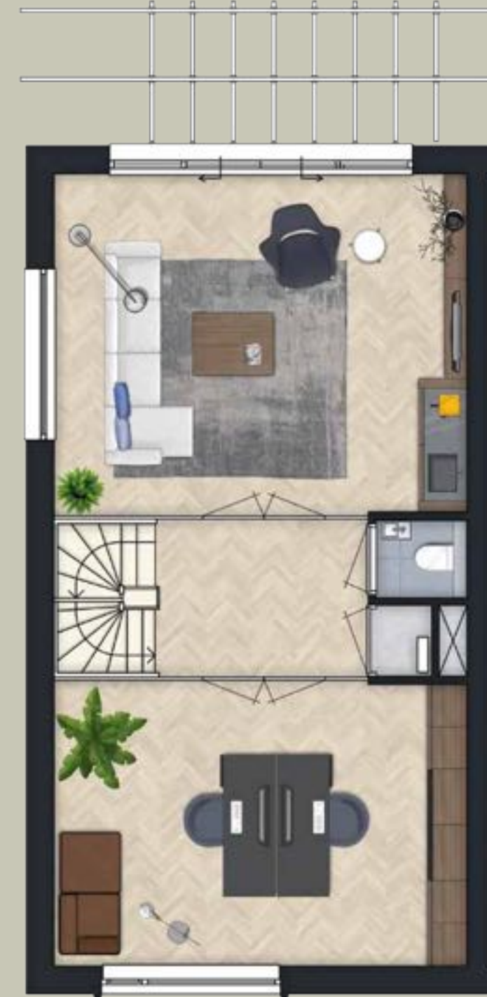
KAMERS EN SUITE MET DICHT WAND EN OPENSLAANDE DEUREN, EXTRA TOILET EN EEN KAST
